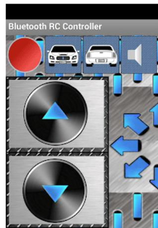
Para configurar el Bluetooth ve a "Option Menu" → "Connect to car" y busca en la lista el HC-06 que has vinculado con tu *smartphone* previamente. Cuando esté correctamente conectado, el indicador rojo parpadeante se pondrá de color verde, indicando una correcta conexión con el Code&Drive. Ya
