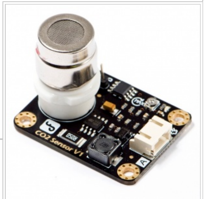
CO2 Sensor (Arduino compatible) SKU:SEN0159
